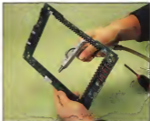
Pulizia dei bobbinetti e dei LED del touch screen.
